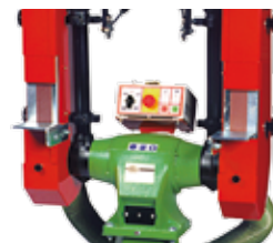
Esempio di applicazione del comando in bassa tensione BT-2 su sbavatrice SNA-4
